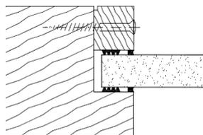
Encadrement des deux côtés de la baguette à verre à recouvrement Vitrage anti-feu EI30 (17mm)
